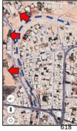
الصورة (9) مسار مجرى السيل (خط أزرق متقطع) مواقع فيضان المياه نحو المحال التجارية (الأسهم الحمراء)
