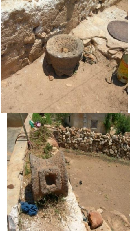
الشكل(16): حجان بازلتيان يستخدمان في طحن الحبوب، قرية أم نير القبيلية. أما النموذج الثاني عبارة عن عجلتين دائرتي الشكل، السطح الأفقي لكلا القرصين محزز بشكل أفقي لتسهيل عملية طحن الحبوب، في وسط القرص يوجد ثقب يخترق
