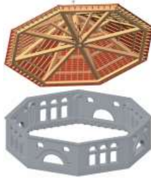
الصورة (2) كنيسة قلعة سماعيل - إعادة بناء الجسم المئمن العلوي مع تخيل لنجارة السقف (Biscop)
