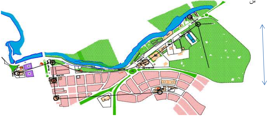
(شكل 2) مخطط سير قنوات الري لناعورتي توأم العثمانيتين ومواقع التغذية المائية استنادا للمعلومات التاريخية
