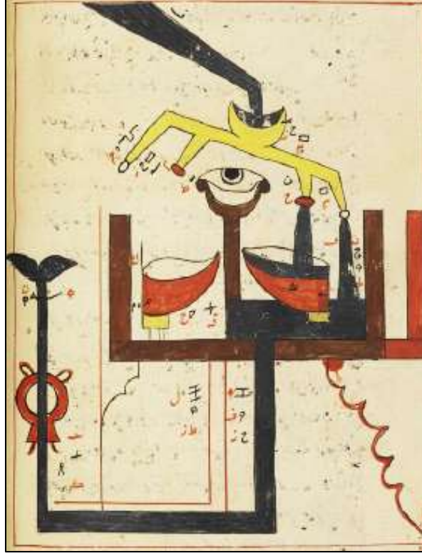
(الشكل 14) فوارة الجزري الأولى ذات الكفتين (تمثل حالة خروج الماء على هيئة قضيب) (الجزري، مخطوط المكتبة البريطانية، ورقة 118ظ)
