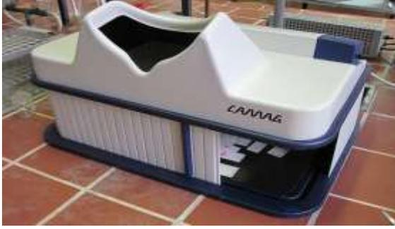
الشكل (2): جهاز CAMMAG UV Cabinet
