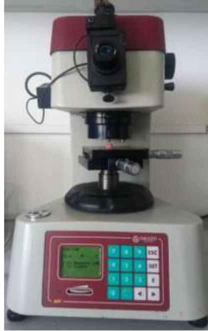
الشكل (2): مقياس القساوة المجهرية
