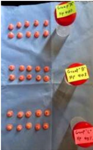
الشكل (1): تعريض عينات الراتنج المركب لبيروكسيد الهيدروجين 40%.
