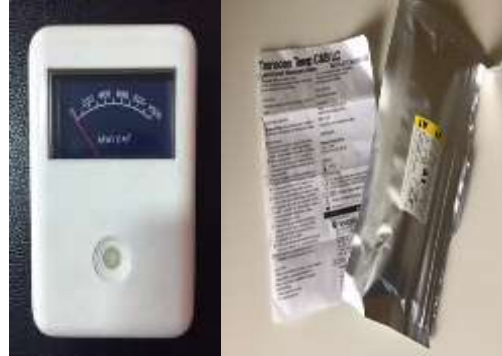
الشكل (1): مادة الأكريل المؤقت المستخدمة في الدراسة وجهاز قياس شدة ضوء جهاز التصلب.
