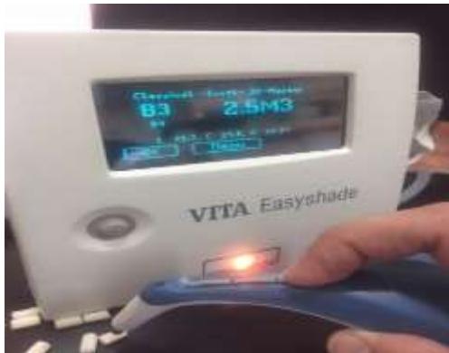
الشكل (4): جهاز Vita Easy Shade المستخدم في قياس لون النماذج بعد الغمر بالملونات.
