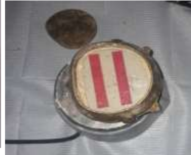
الشكل رقم (2) مرحلة صب الجبس على الهزاز الالي وإزالة الزوائد الشمعية بواسطة المياه الساخنة
