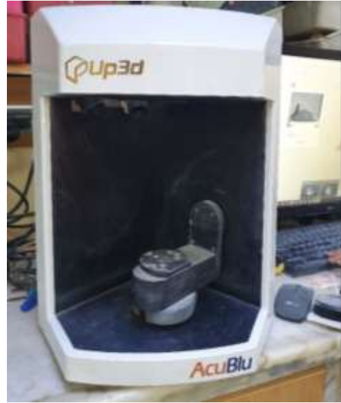
الشكل (2-3) يوضح الماسح الضوئي المستخدم في تصوير الامثلة أجري مسح ثلاثي الابعاد لكل دعامة قبل التحضير وبعد التحضير فحصلنا على صورة ثلاثية الابعاد
