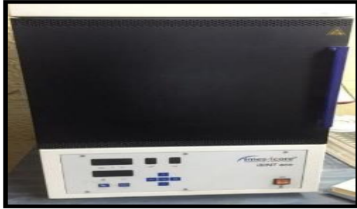
الشكل (٥): فرن ارتصاص الزيركونيا الخاص بنظام zircodenta من شركة Imes-Icor.
