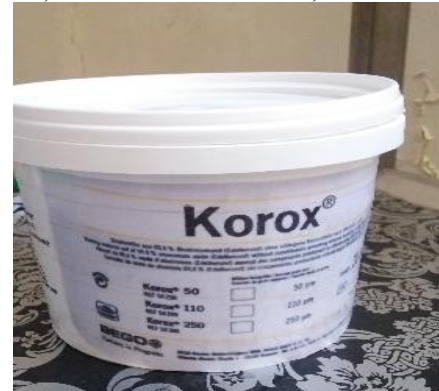
الشكل (٣) حبيبات أكسيد الألمنيوم بحجم ١١٠ ميكرون (Korox, BEGO, Bremen, Germany)
