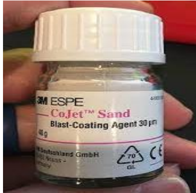
الشكل (٤) حبيبات أكسيد الألمنيوم ٣٠ ميكرون مغطاة بالسيليكا (COJET SAND, 3m ESPE AG. ESPE Platz Seefiel. Germany) أجهزة الدراسة:
