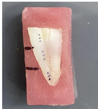
الشكل ٤: يوضح عينة محدد عليها السن مقسم الى ٣ اقسام. طبق هرم ماسي بزاوية ١٣٦ درجة على سطح كل سن بنقل ٣٠٠ غ لمدة ١٥ ثانية (الشكل ٥) ليتشكل انطباعٌ معيني الشكل ناتج عن ضغط الهرم على السطح المدروس (Khallaf et al., 2020).
