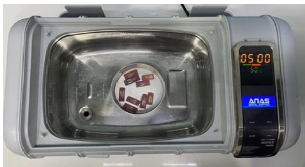
الشكل ٣: العينات مغمورة ضمن هزازة الأمواج فوق الصوتية ذات المؤقتة الزمنية.
