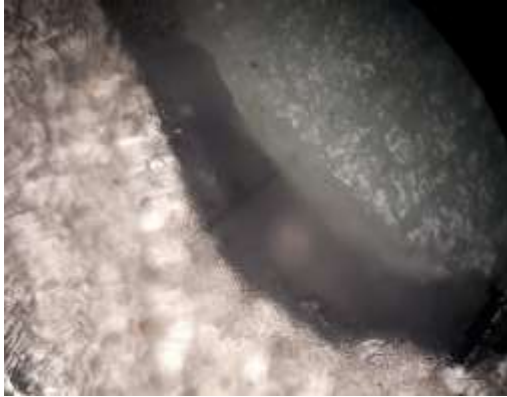
الشكل (20): صورة توضح قياس الانطباق الداخلي في منطقة الزاوية الخطية الإطباقية الدهليزية بواسطة طريقة المجهر الضوئي.
