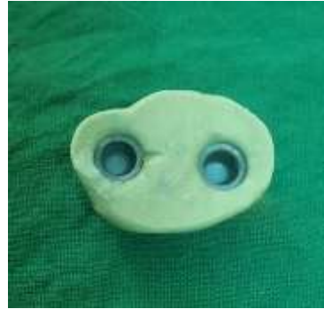
الشكل (8): كتلة المطاط وبداخلها القلنسوات المعدنية.
