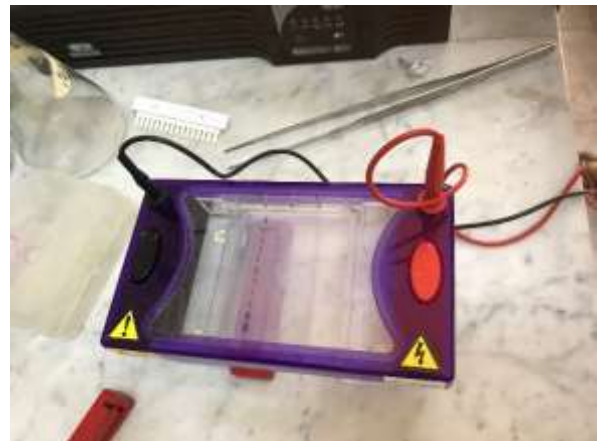
الشكل(5): يوضح حوض وجل الرحلان بعد حقن العينات
