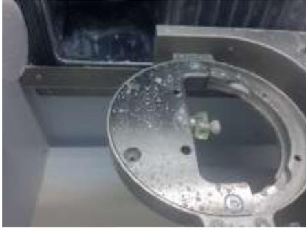
الشكل (5): عملية النحت مع التبريد بالماء.
