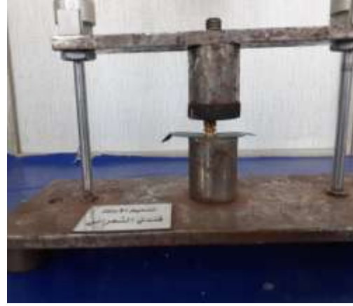
الشكل (7) إحدى العينات ضمن جهاز توحيد قوة الضغط
