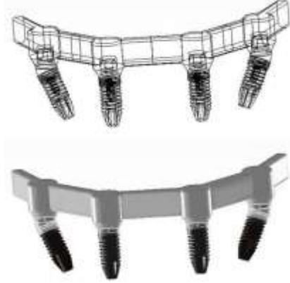
الشكل (2): الهيكل مع الدعامات والغرسات
