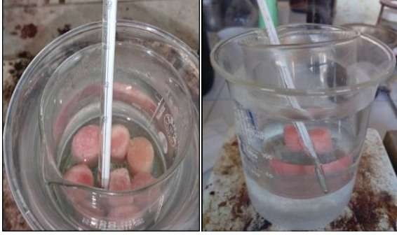
الشكل(5): العينات داخل المحلول الحمضي (H2SO4+HCl) مع الحفاظ على درجة حرارة 70 درجة مئوية في أثناء التخريش.
