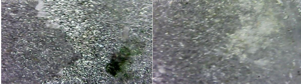
الشكل (17): صورة بالمجهر توضّح نمط الإخفاق الحاصل في سطح خليطة النيكل كروم المرملة والمخرشة بمزيج من حمض الكبريت وحمض كلور الماء بعد فك ارتباطها. (أ): إخفاق تماسكي (Cohesive)، (ب): إخفاق مختلط
