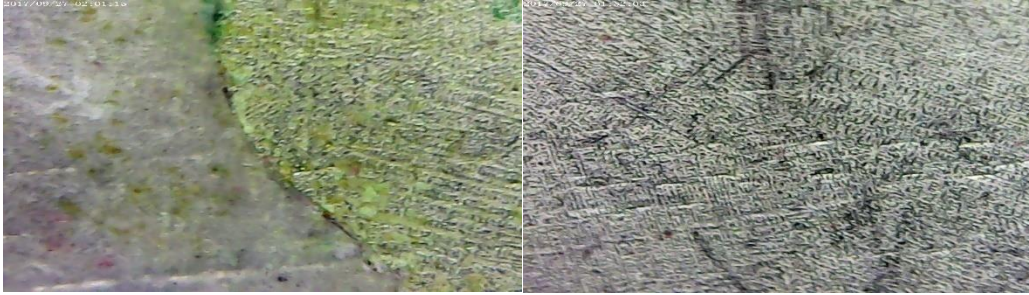
الشكل (15): صورة بالمجهر توضّح نمط الإخفاق الحاصل في سطح خليطة النيكل كروم الصقيلة والمخرشة بـ حمض كلور الماء المركز بعد فك ارتباطها. (أ): إخفاق ارتباطي (Adhesive)، (ب): إخفاق مختلط
