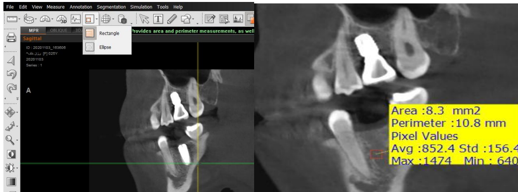
الشكل (2): يوضح طريقة قياس الكثافة الشعاعية في نافذة البرنامج عن طريق اختيار الرمز (ROI) ومن ثم اختيار (Rectangle)
