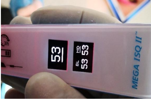
الشكل(6): مقدار ISQ على جهاز OSTELL بعد ادخال الزرعة بعزم منخفض
