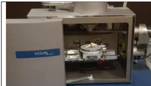
الشكل (9): مراحل ترتيب العينة على الحوامل لإدخالها إلى حجرة المجهر الماسح
