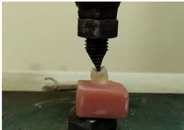
الشكل (2): اختبار قوة الضغط على العينات
