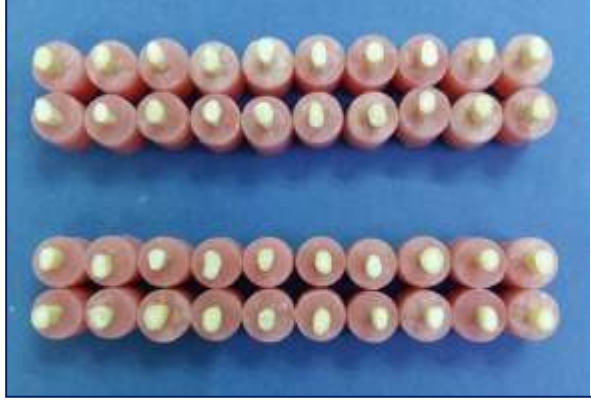
الشكل رقم (3): يبين القوالب البلاستيكية المستخدمة في الدراسة، وبعض جذور العينة بعد تهيئتها لاختبار مقاومة الكسر.
