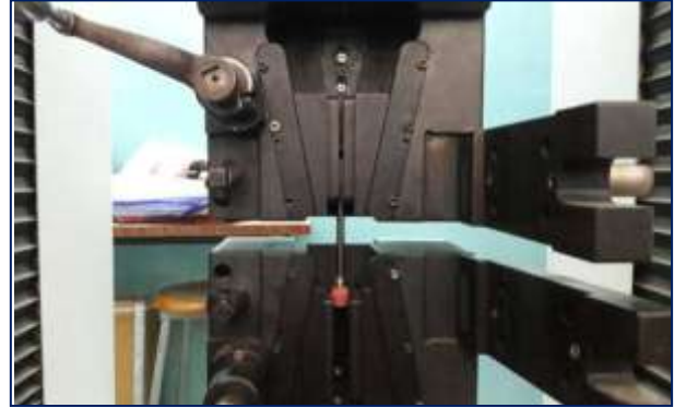
الشكل رقم (5): يبين الجهاز المستخدم في الدراسة لإجراء اختبار مقاومة الكسر.
