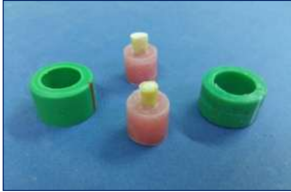
الشكل رقم (4): يبين العينة كاملة بعد تهيئتها لاختبار مقاومة الكسر.
