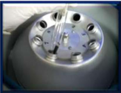
الصورة (1): وضع السن المصنوع بالأنبوب البلاستيكي بعد حقن أزرق الميتيلين داخل أنبوب الاختبار ثم في المثقلة.
