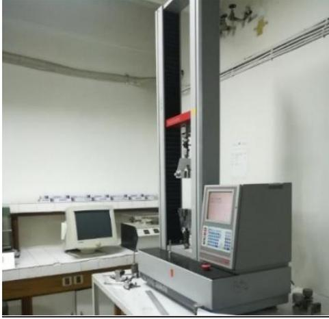
الشكل (9): جهاز الاختبارات العام Testometric في مركز الاختبارات
