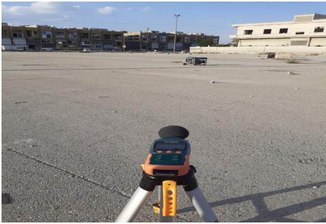
الشكل (5) قياس شدة الصوت للمولد بدون حاوية عازلة للصوت.
