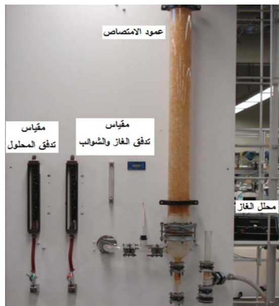
الشكل (7) برج الامتصاص المخبري لقياس معدل امتصاص المحاليل للشوائب من الغازات
