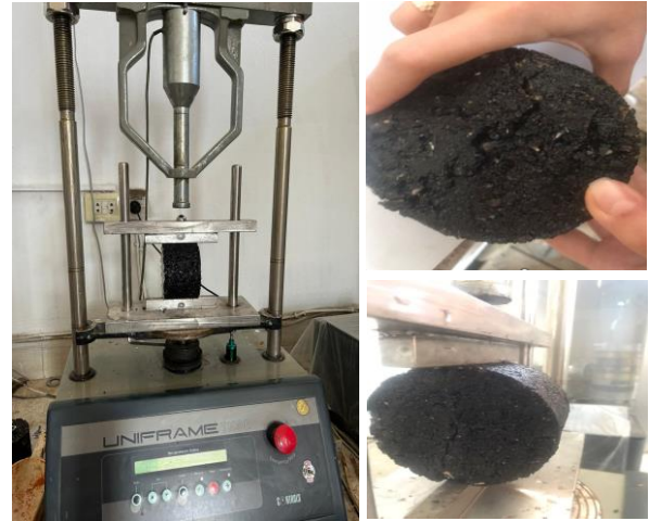
الصورة (3) صور لتجربة ITS (حيث تم اجراء التجارب بمخبر الطرق في كلية الهندسة المدنية - جامعة دمشق)
