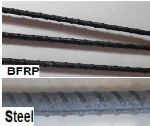
الشكل (3) يبين سطح قضبان BFRP والقضبان الفولاذية المستخدمة بالبحث. (الدراسة الحالية)
