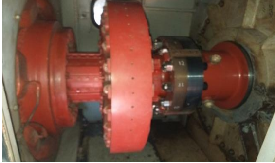
الشكل (12) يبين المحمل المهتز ومستوي الموازنة القريب منه
