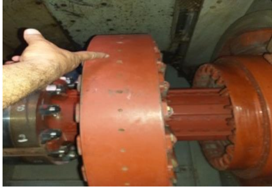
الشكل (13) يبين مستوى الموازنة ومكان توضع كتل الموازنة
