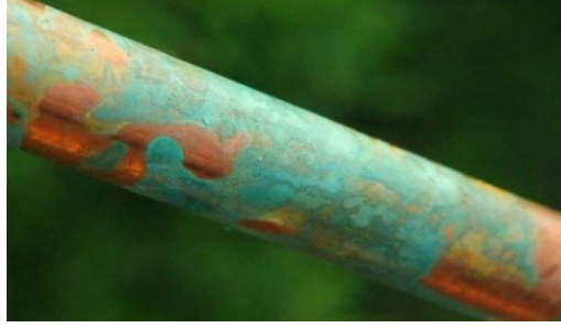
الشكل(12) تشكيل طبقة الزنجار على أنبوب النحاس.
