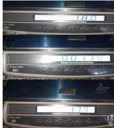
الشكل (5) وزن عينات الفولاذ قبل الاختبار.
