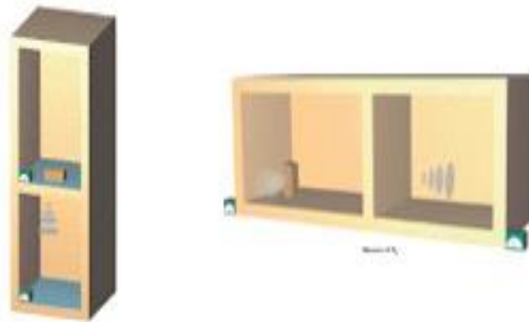
Impact sound (insulation) وفق EN ISO 140-6 Airborne sound (insulation) وفق EN ISO 140-3 الشكل (9): رسم توضيحي لطريقة اختبار كفاءة عزل الصوت (Arval, 2009,118-119).
