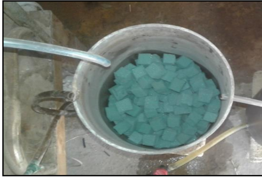
الشكل (3) الحامل الاسفنجي قبل نمو الكتلة الحيوية عليه
