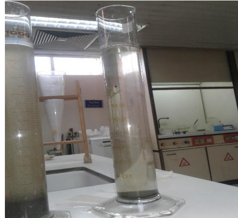
الشكل (5) ترسيب عينة الحمأة لمدة 30min في عمود الترسيب
