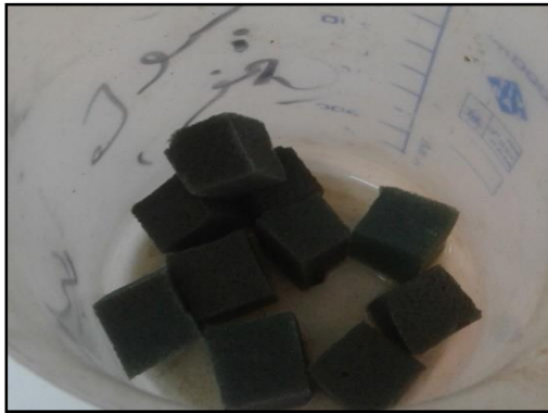
الشكل (4) الحامل الاسفنجي بعد نمو الكتلة الحيوية عليه
