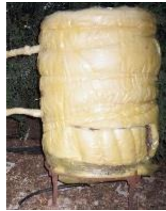
الشكل (5) المفاعل البيوحراري في وضع التشغيل
