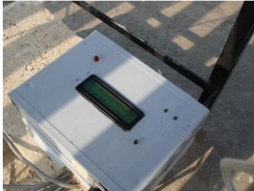
الشكل (11) نظام قياس درجات الحرارة المستخدم في التجارب.
