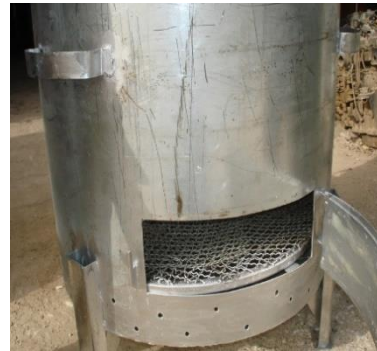
الشكل (2) المفاعل البيوحراري المستخدم في الدراسة.
