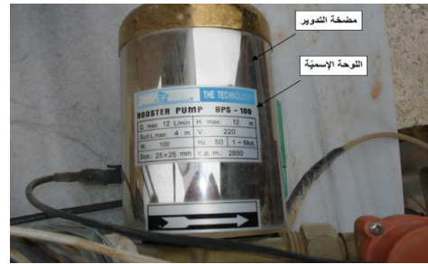
الشكل (9) المواصفات الاسمية لمضخة التدوير المستخدمة في التجربة.
