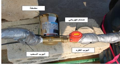
الشكل (10) مضخة التدوير المستخدمة في التجارب.
