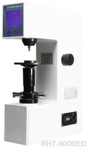
الشكل (4) جهاز اختبار روكويل RHT-9000ED من شركة Metrology التايوانية.
