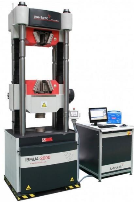
الشكل (6) جهاز اختبار الشد من شركة IBERTEST
