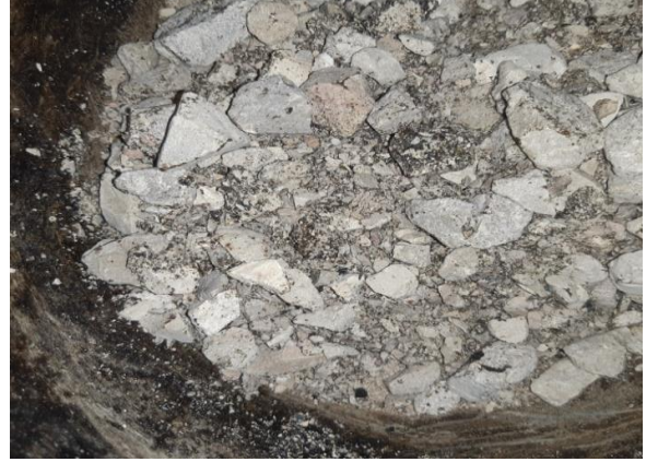
الشكل رقم (22) شكل حبيبات (HDPE) عند إضافتها للحصىات الساخنة
