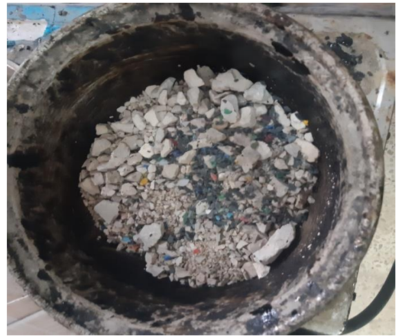
الشكل رقم (15) الخلط بالطريقة الجافة (HDPE)
