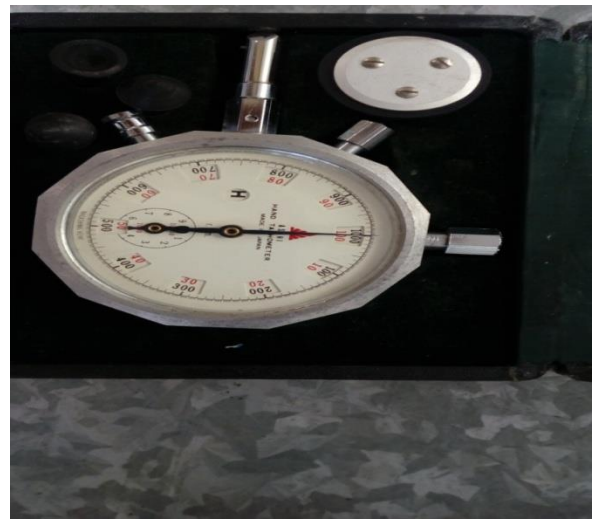
الشكل رقم(3) جهاز قياس سرعة الدوران
