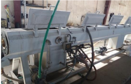
الشكل (12) آلة إنتاج أنابيب (PVC)
