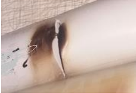
الشكل (29) أحد العينات المتشققة نتيجة اختبار الضغط الداخلي
