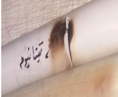
الشكل (30) أحد العينات المتشققة نتيجة اختبار الضغط الداخلي
