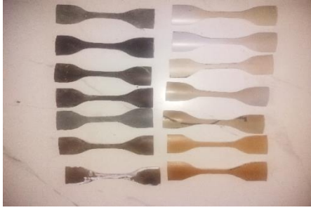
الشكل (14) عينات الشد المقطعة من الانابيب
