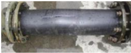
الشكل (28) أحد العينات المتشقة نتيجة اختبار الضغط الداخلي
