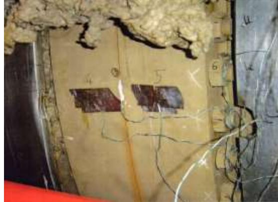
الشكل (1) توضع حساسات قياس درجة الحرارة
