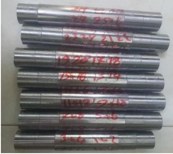
الشكل (6) يبين العينات بعد إجراء عملية الخراطة
