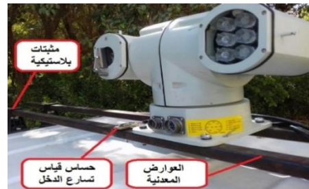
الشكل (15): صورة لطريقة تحميل المنصة على العربة
