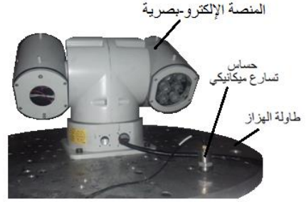
الشكل (11): اختبارات المسح الطبقي للمنصة موضوع البحث
