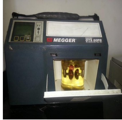
الشكل(1) جهاز قياس توتر الانهيار للعينات المدروسة.
