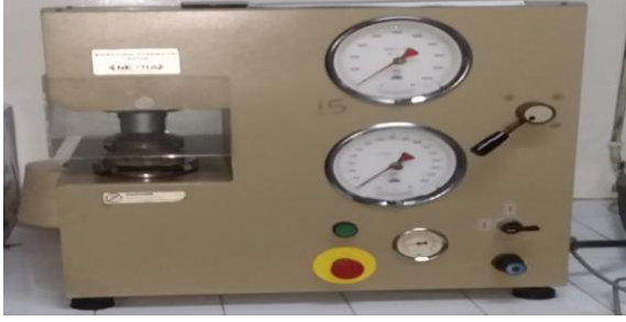
الشكل (12)، جهاز GT-C12A لتحديد قوة الانفجار
