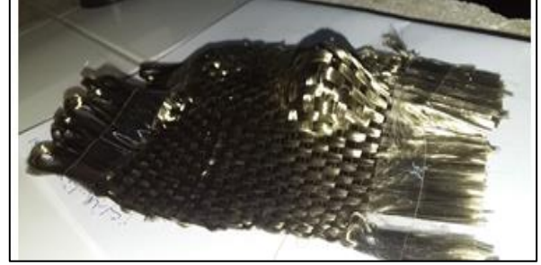
الشكل رقم (13)، عينة بازلتية بعد تطبيق اختبار قوة الانفجار
