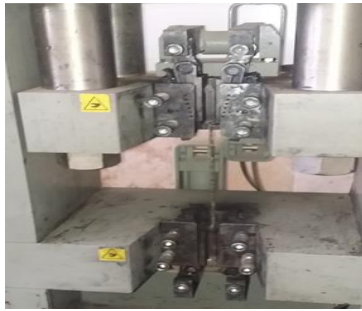
الشكل (15) تطبيق اختبار الشد للحبال البازلتية
