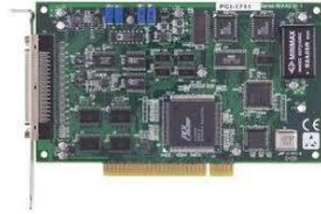
الشكل (38) كرت التحصيل PCL1711 ADVANTEC
