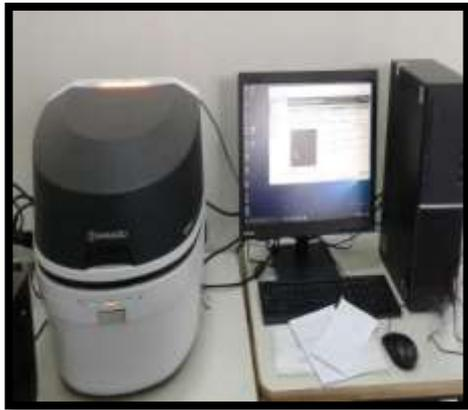
الشكل (3) جهاز تحديد العناصر الكيميائية بطريقة تشتت طاقة الأشعة السينية (EDX) .
