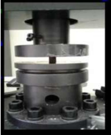
الشكل (20) وضع العينة بوضع متمركز مع قرص الجهاز في اختبار المقاومة على الانضغاط.
