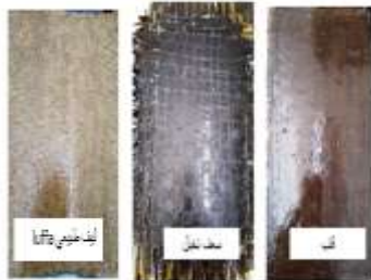
الشكل (4) صورة توضح عينات البولي استر غير المشبع المسلحة بأنواع مختلفة من الألياف الطبيعية
