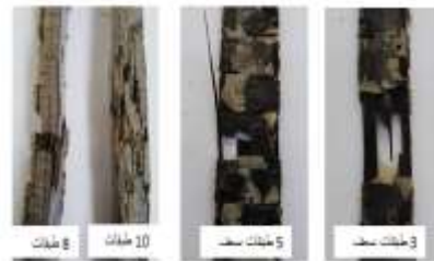
الشكل (9) صور فوتوغرافية لموقع الكسر عند التسليح بعدد مختلف من طبقات سعف النخيل
