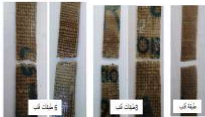
الشكل (10) صور فوتوغرافية لموقع الكسر عند التسليح بعدد مختلف من طبقات نسيج القنب
