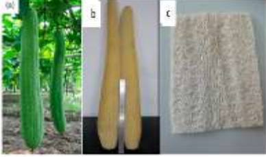
الشكل (3) صورة توضح الليف الطبيعي (a) النبات الأخضر، (b) بعد الغسل والتجفيف، (c) الحصيرة النهائية
