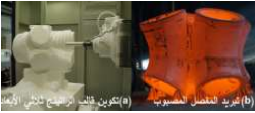
الشكل (16) تشكيل المفصل المصبوب للعمود الشجري (Boake, 2011, p. 33)
